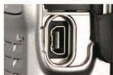
USB разъем также находится на боковой стороне радиостанции. Микрофон с камерой (MH-85A11U) также может быть подключен к данному порту. Ваш персональный компьютер может быть подключен к данному порту для обновления прошивки радиостанции.
