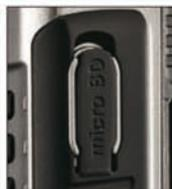
Слот Микро SD карты находится на боковой стороне радиостанции. GPS регистратор записывает местоположение и информацию о движущейся станции в файл записи памяти в радиостанции; данные об изображении и другая полезная информация хранится на микро SD карте. Используя SD карту, возможно клонировать данные из радиостанции на другие станции FT1DR/E.
